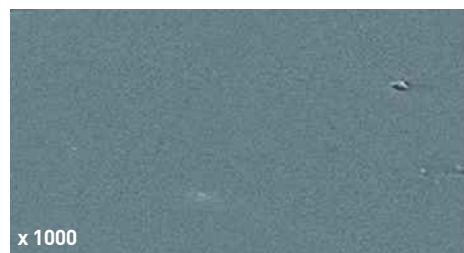
Vergrößerung des Duschkabinenglases TIMELESS nach täglicher Benutzung: Es sind keine rauen Stellen zu erkennen
