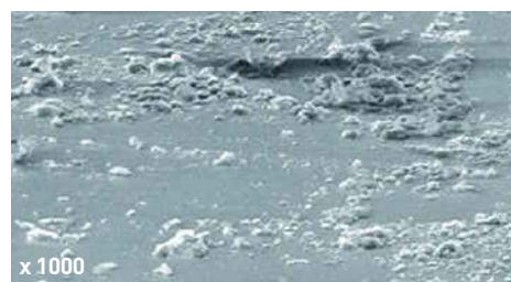
Vergrößerung eines herkömmlichen Duschkabinenglases nach täglicher Benutzung: Raue Stellen sind deutlich sichtbar.
